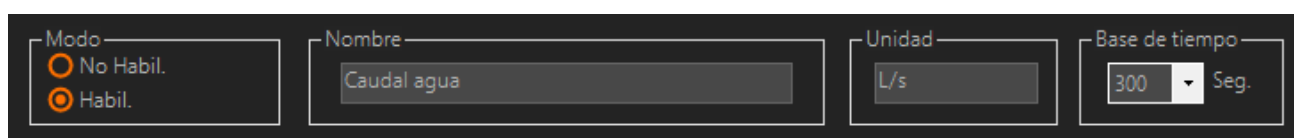
Detalle de interfaz de configuración de caudalímetros
