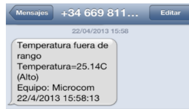
Ejemplo de mensaje SMS enviado por alarma por temperatura fuera de rango
